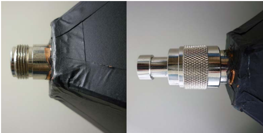
Obrázek 19 Vysokofrekvenční konektor bez a se zakončenou impedancí.
