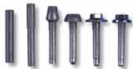
Obr. 4.8 Postup výroby šroubu tvářením zastyděl [10]
