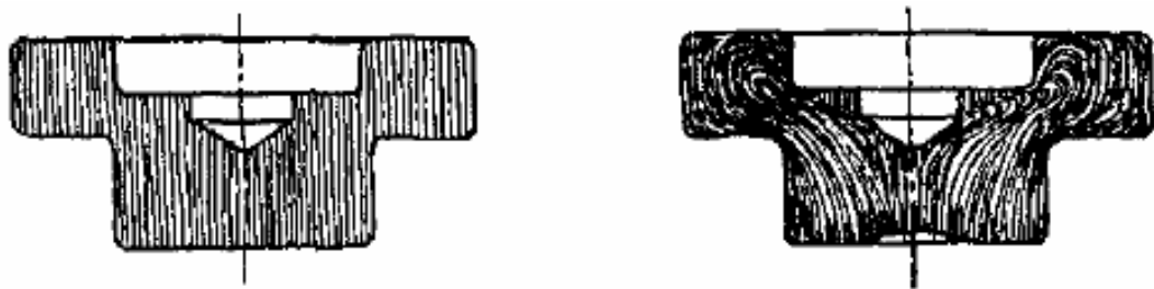
Obr. 4.7 Průběh vláken v obráběné a tvářené součásti [1]
