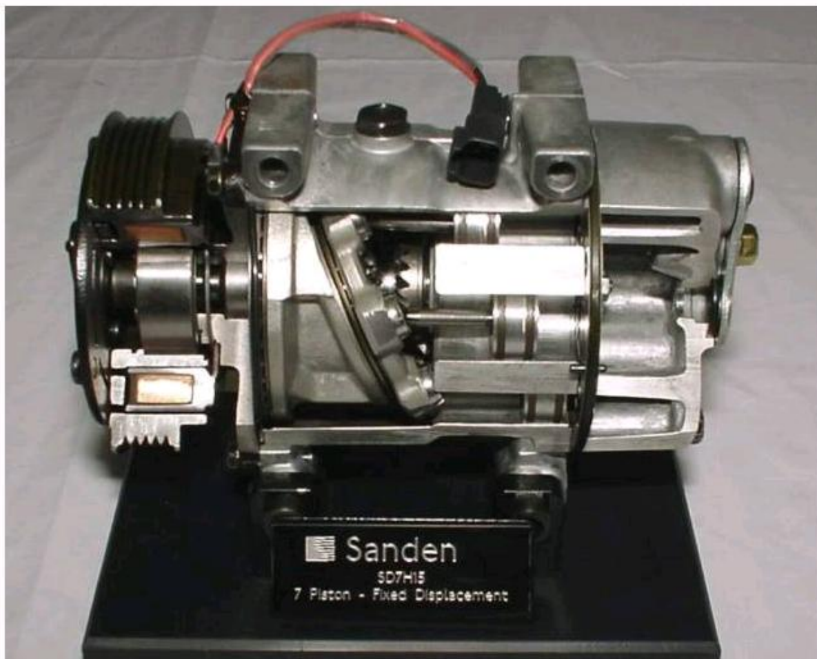
Obr. 11: Kompresor s kyvnou deskou. Převzato z [6]
