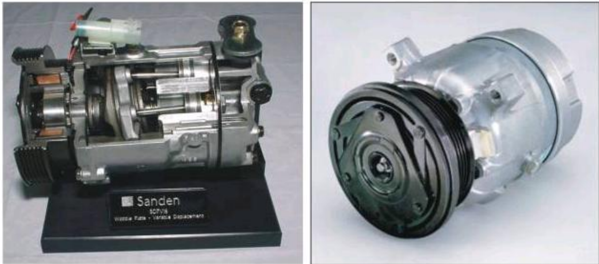
Obr. 12: Kompresor s houpavou deskou. Převzato z[6]
