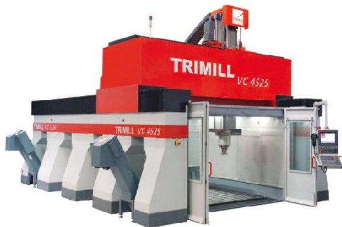
OBRÁZEK 6: Vysokorychlostní CNC portálové obrábací centrum (3-ti osé) Trimill (Zdroj: http://www.trimill.cz/en/produkty/53-trimill-vc-4525.html [online])
