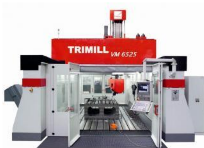
OBRÁZEK 4: CNC vysokorychlostní obráběcí centrum (5-ti osé) Trimill (Zdroj: http://www.robur.ee/trimill_vm_4525_est.html [online])
