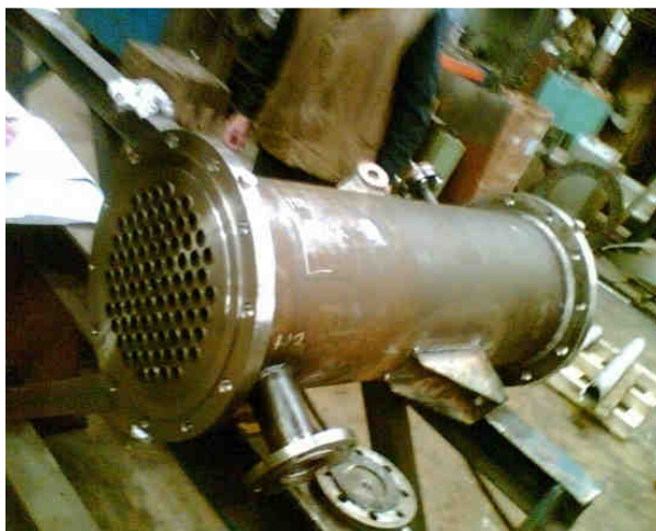
Obr.15: Fotografie výměníku z montáže z Královopolské Brno
