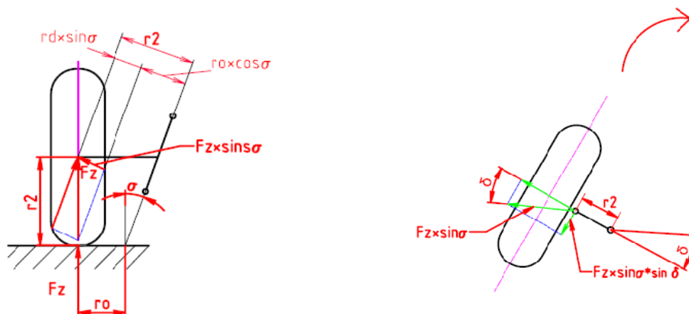
Obr. 8 Grafické znázornění určení vratného momentu, zdroj [1]
