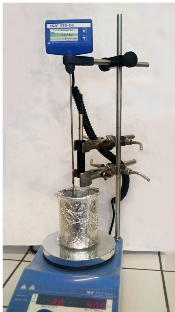
Obr. 56: Aparatura pro sorpci analytů na SPME vlákno
