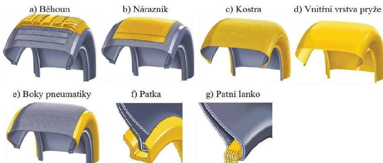
Obr. 3 Konstrukce bezdušové pneumatiky [12]
