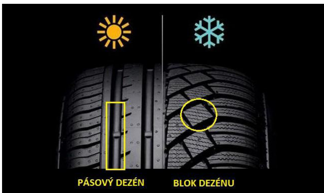
Obr. 4 Detail dezénu letní a zimní pneumatiky [35]
