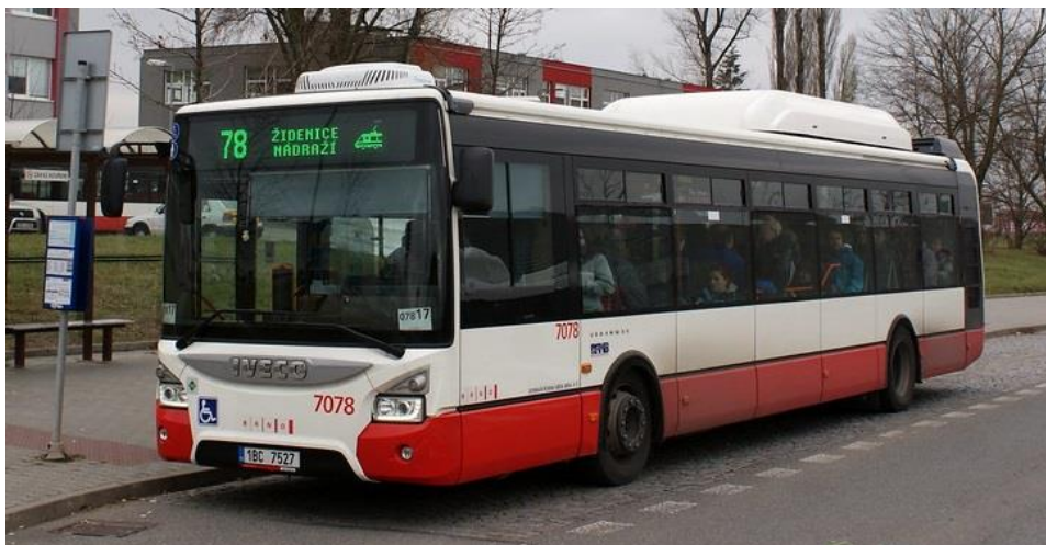
Obrázek 11 Iveco Urbanway 12M CNG s viditelnou nádrží na CNG na střeše [36]
