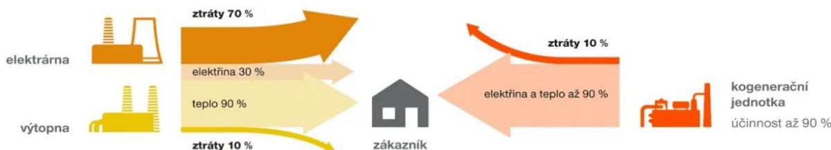
Obrázek 9 Porovnání energetické účinnosti kogenerace [29]
