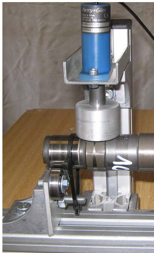
obr.4-4 Přitáhnutí vačkového hřídele elektroinstalační svorkou
