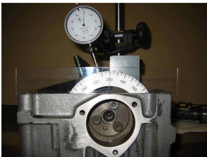
obr.2-2 Měření geometrie vačky přímo na motoru [7]
