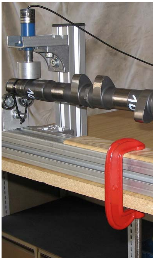
obr.4-3 Upnutí rámu k pracovní desce pomocí stolařské svěrky
