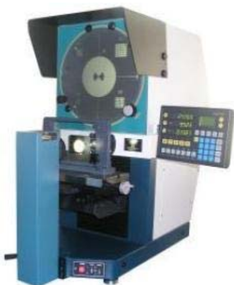
obr.2-3 Klasický profilprojektor JT-25 [ 8 ]
