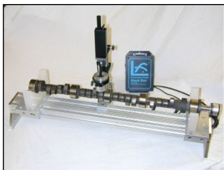
obr.3-3 Přístroj pro kontrolu vaček firmy Performance Trends Inc. [11]
