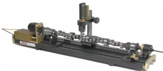
obr.3-5 Dvě provedení měřících přípravků Andrews M26 a M46. [12]
