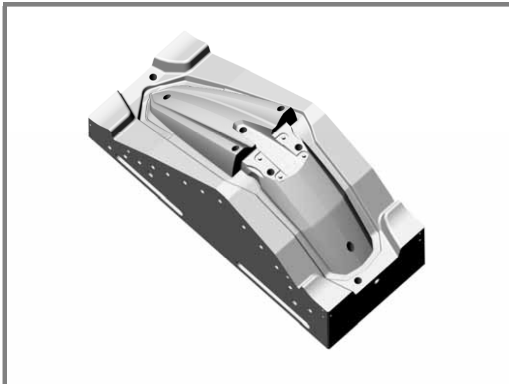
Obr. 60 Forma na blatník - pohyblivý díl, tvarové zámky
