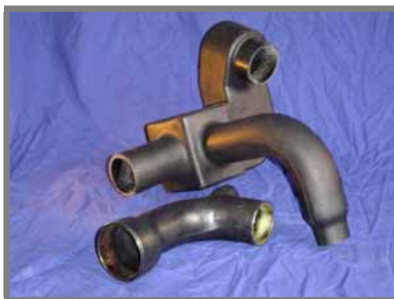
Obr. 12 Tvarově složité součásti vyrobené technologií rotačního tváření [23]
