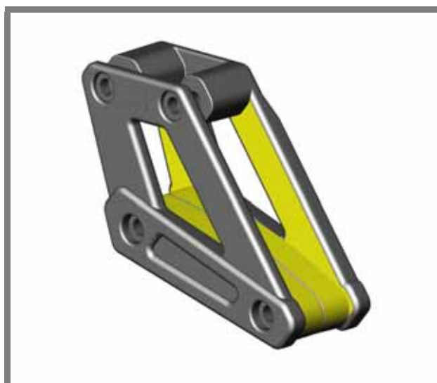
Obr. 50 Vodítko řetězu - vodící plochy zvýrazněny žlutě
