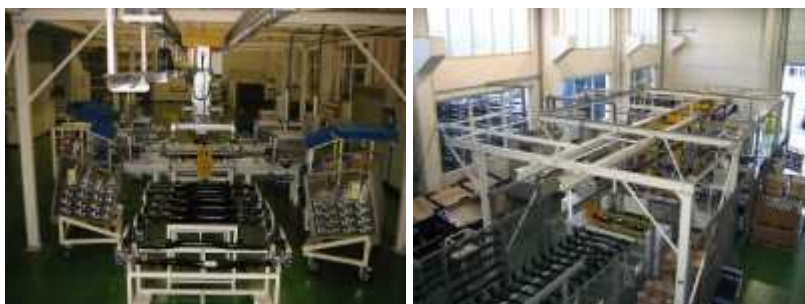
Obrázek 3 - Příklad produktu společnosti JHV - ENGINEERING s.r.o - Linka na montáž a testování zadních náprav osobního automobilu
