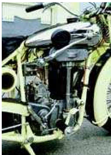
Obr. 20 Motocykl Praga BD 500 s pohonem královským hřídelem [13]
