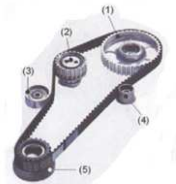
Obr. 19 Popis jednotlivých částí řemenové pohonu rozvodu [3]
