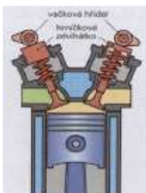
Obr. 5 Motor s dvojicí vačkových hřídelí (DOHC) [1]
