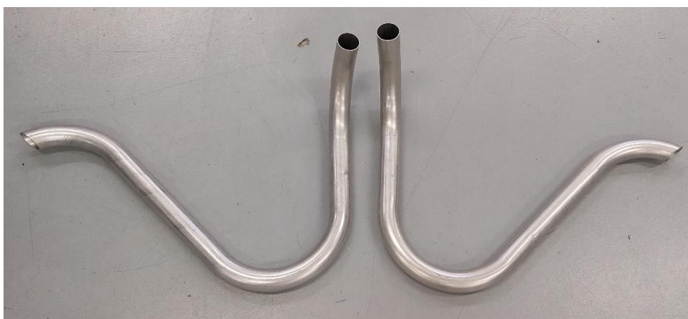
Obr. 45 Dílce po odřezání přebytečných částí.
