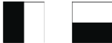
Obrázok 4.10 Haar-ove vlnky, ľavý filter vypočítava odozvy v ose x a pravý v ose y
