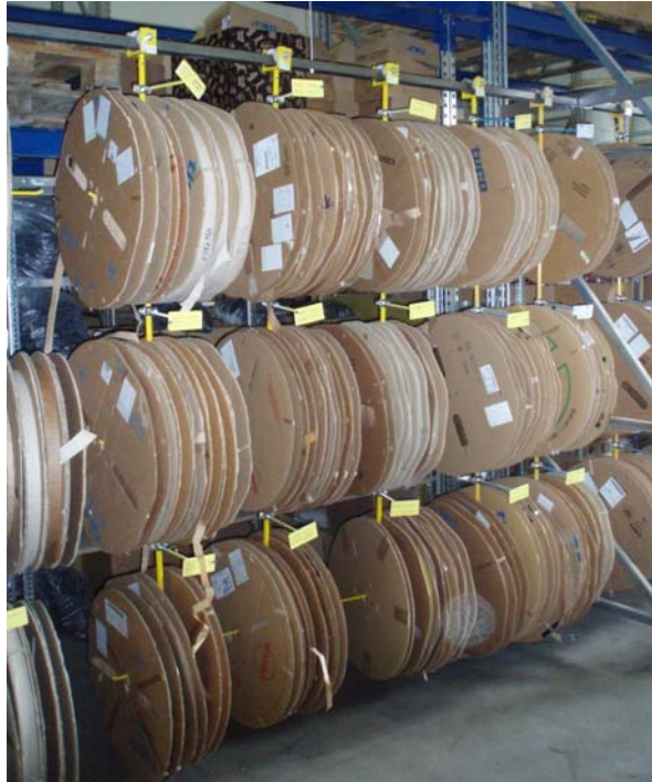
Závěsný systém - uložení kontaktů
