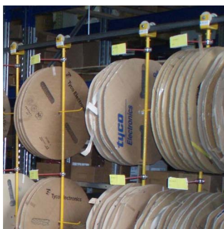
Obrázek 8: Uskladnění kontaktů – závěsný systém (Zdroj: Vlastní zpracování)
