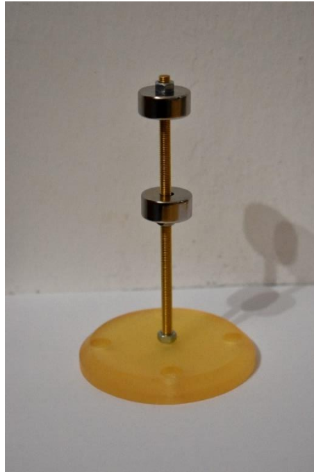
Obrázek 12: Systém uchycení permanentních magnetů
