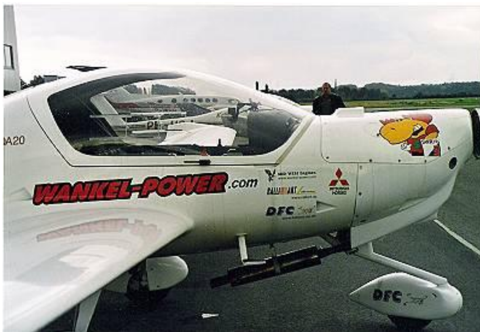
Obr. 14– Diamond Katana DA20 s pohonnou jednotkou Wankel
