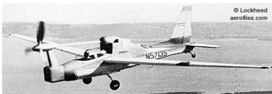
Obr. 18 – Lockheed Q Star – první letadlo poháněné Wankelovým motorem
