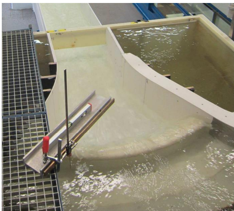
Obrázek 47: Průběh hladiny na fyzikálním modelu [22]
