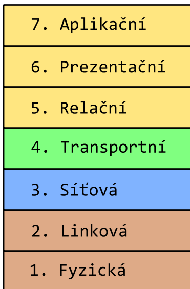
Obr. 7: Vrstvy ISO OSI. (Zdroj: vlastní tvorba)
