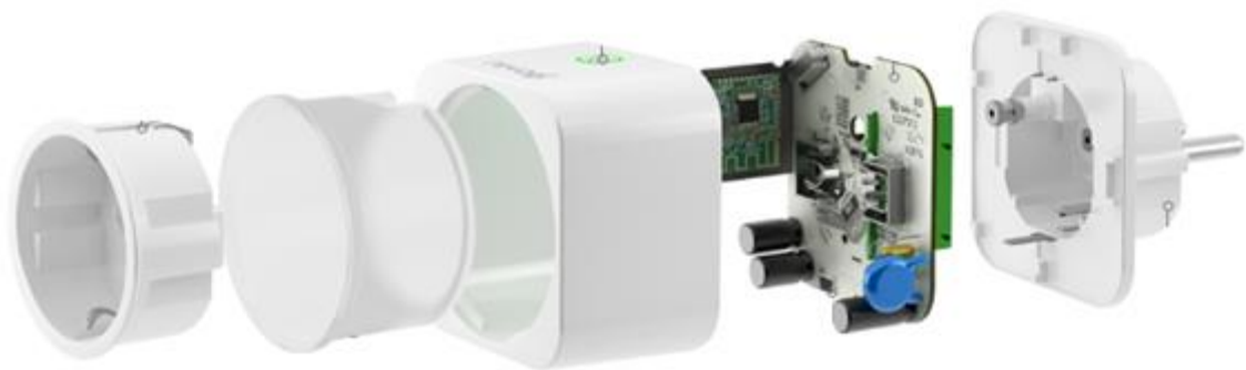
Obr. 4-7: Náhled rozložené zásuvky Revogi Smart Meter Plug Bluetooth SPB012 [29]
