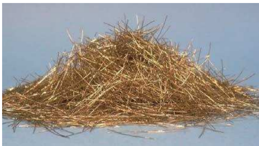
Obr. 8: Ocelová mikrovlákná používaná v UHSC [21]
