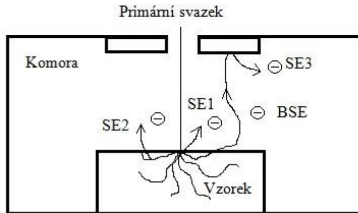
Obr. 6 Příspěvky k celkovému výtěžku sekundárních elektronů poremko dopadu primárních elektronů na v
