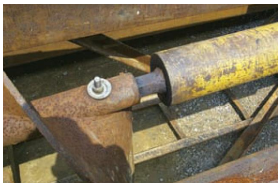
Obrázek 1 Hřídel obdélníkového příčného průřezu přenáší krouticí moment na zemní vrták [9]
