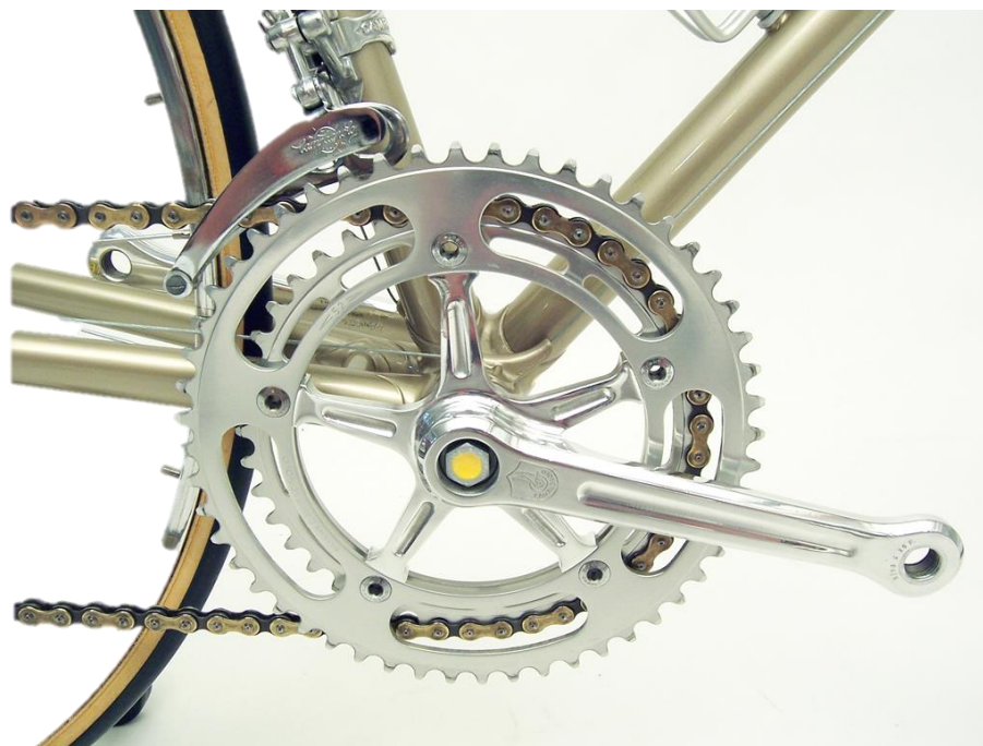
Obrázek 3 Klika šlapátka, která se nasadí na osu s kruhovým příčným průřezem. Samotná klika (s přibližně obdélníkovým příčným průřezem) je pak namáhána cyklicky ohybem a krutem [22].
