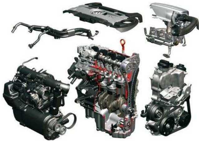
Obr.3.3. Nový přepřehovaný motor 1.2 TSI[8]
