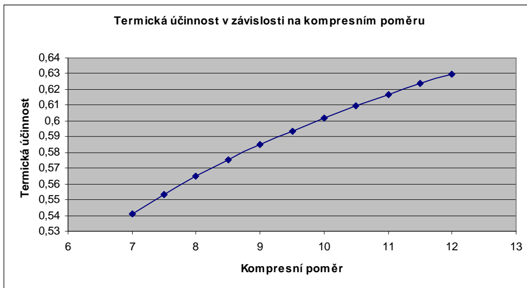
Obr. 5-2 Závislost termické účinnosti na kompresním poměru
