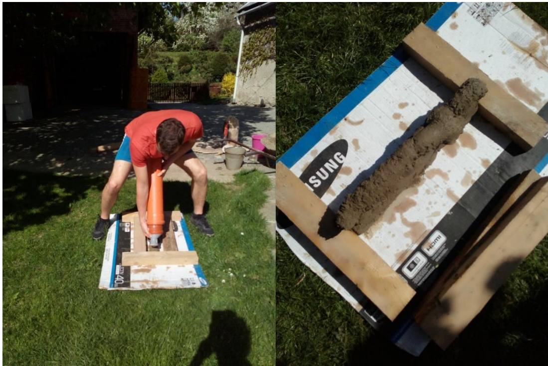
Obr. 36 Proces tisku a finální verze první zkoušky
