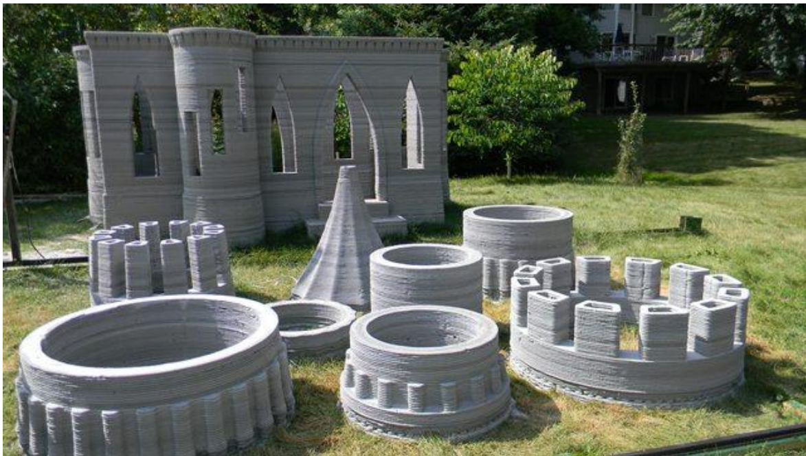
Obr. 24 Tisk jednotlivých částí hradu [18]
