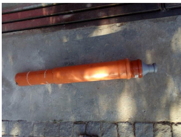
Obr. 29 První verze tiskové hlavy
