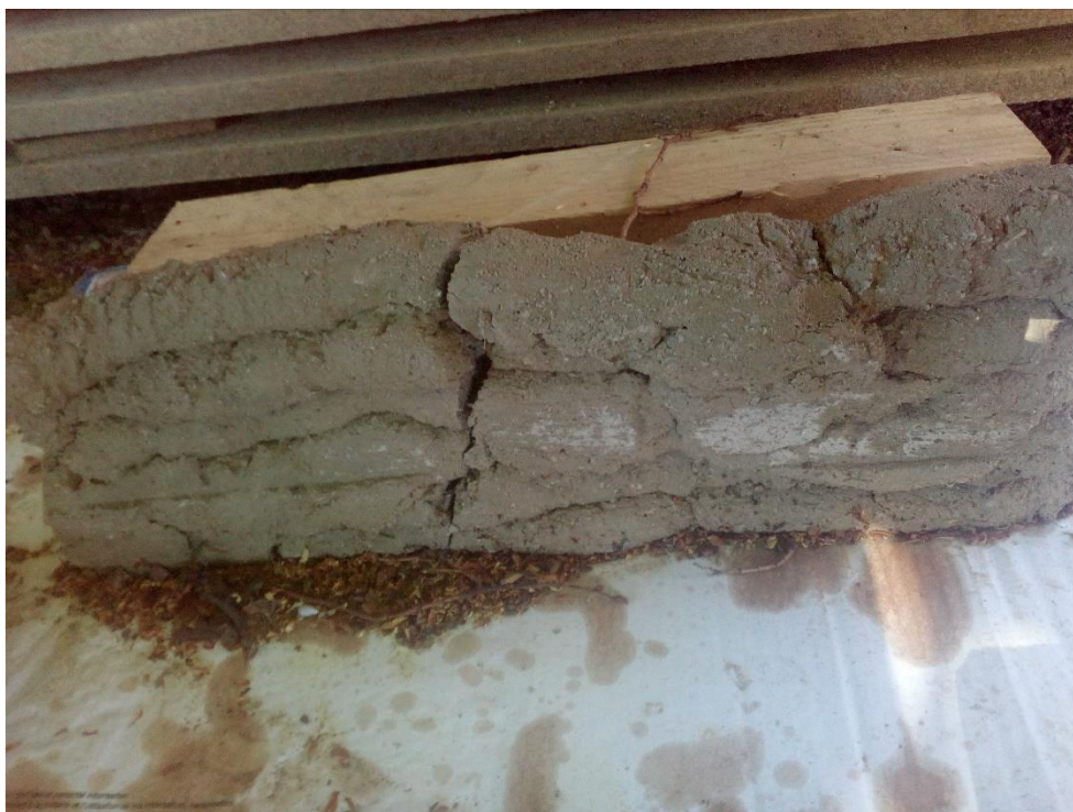
Obr. 41 Výsledek první zkoušky po sedmi dnech
