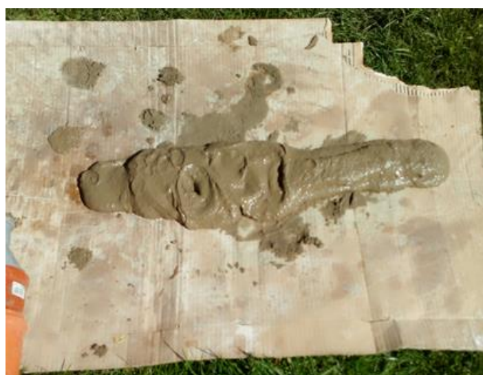
Obr. 32 Příprava cemento hliněné kaše
