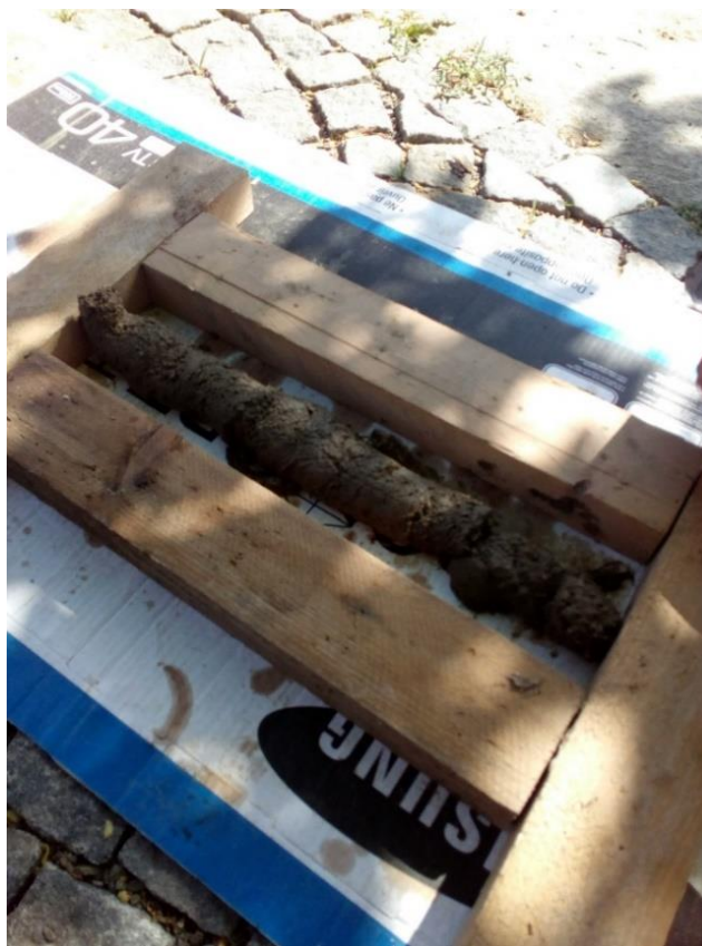
Obr. 34 Vhodná konzistence cemento hliněné kaše
