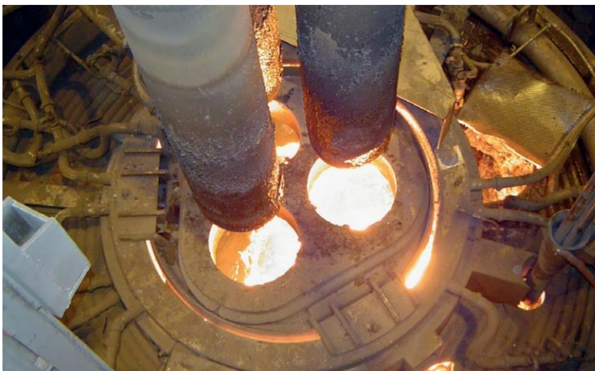
Obr. 3 Zavádění grafitových elektrod do EOP [10]
