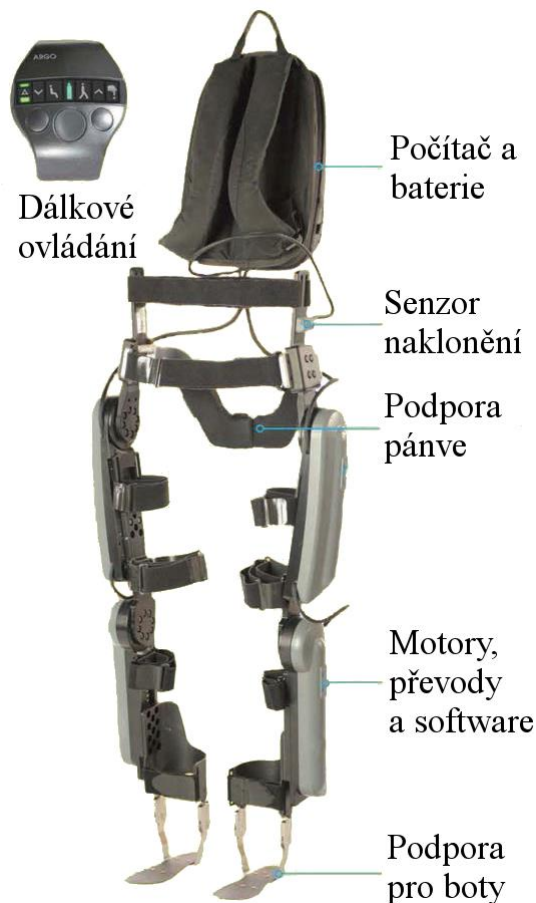
Obr. 4.1 Popis součástí systému ReWalk [9]
