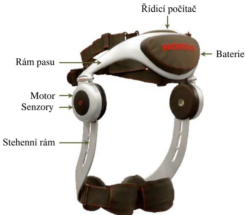
Obr. 4.5 Popis součástí zařízení Walking Assist Device with Stride Management [14]
