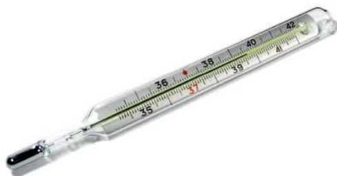
Obrázek 6.1 : rtuťový teploměr (převzato z [13])
