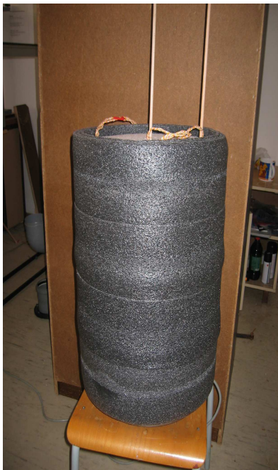
Obrázek 7.1 : experimentální model ohřevu TUV
