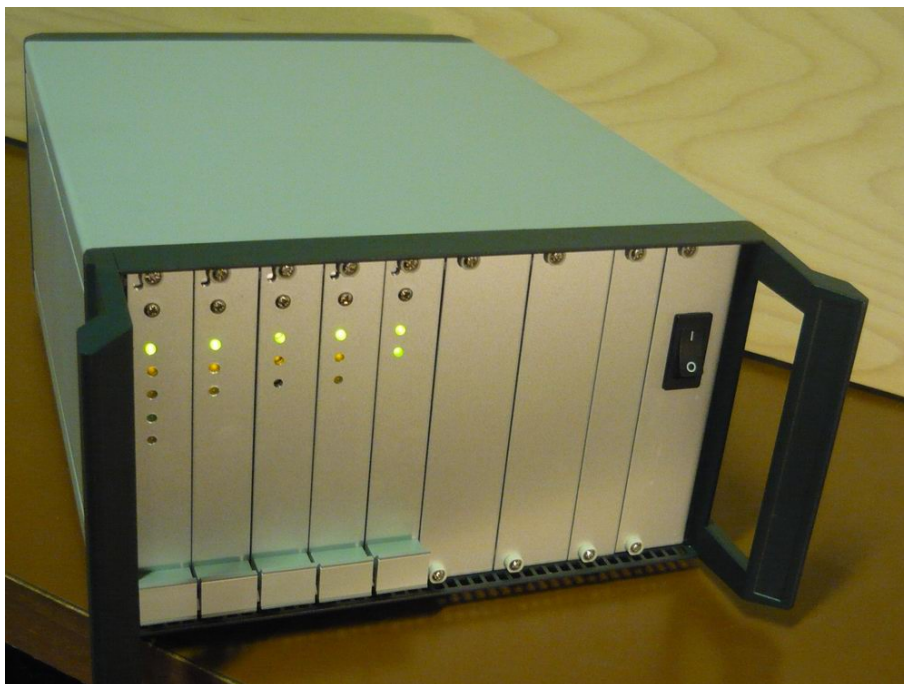
Obr. B.5: Sestavená řídicí elektronika, zapnuto
