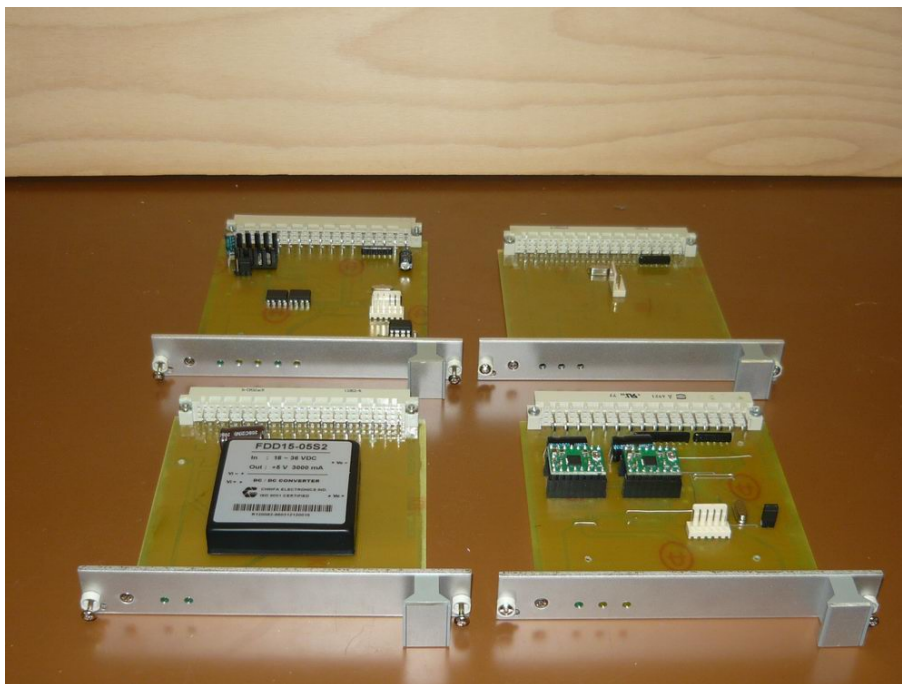
Obr. B.7: Moduly, strana součástek, nahoře: USB, TRI, dole: DC, KROK
