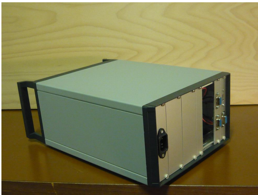
Obr. B.4: Sestavená řídicí elektronika, zadní strana
