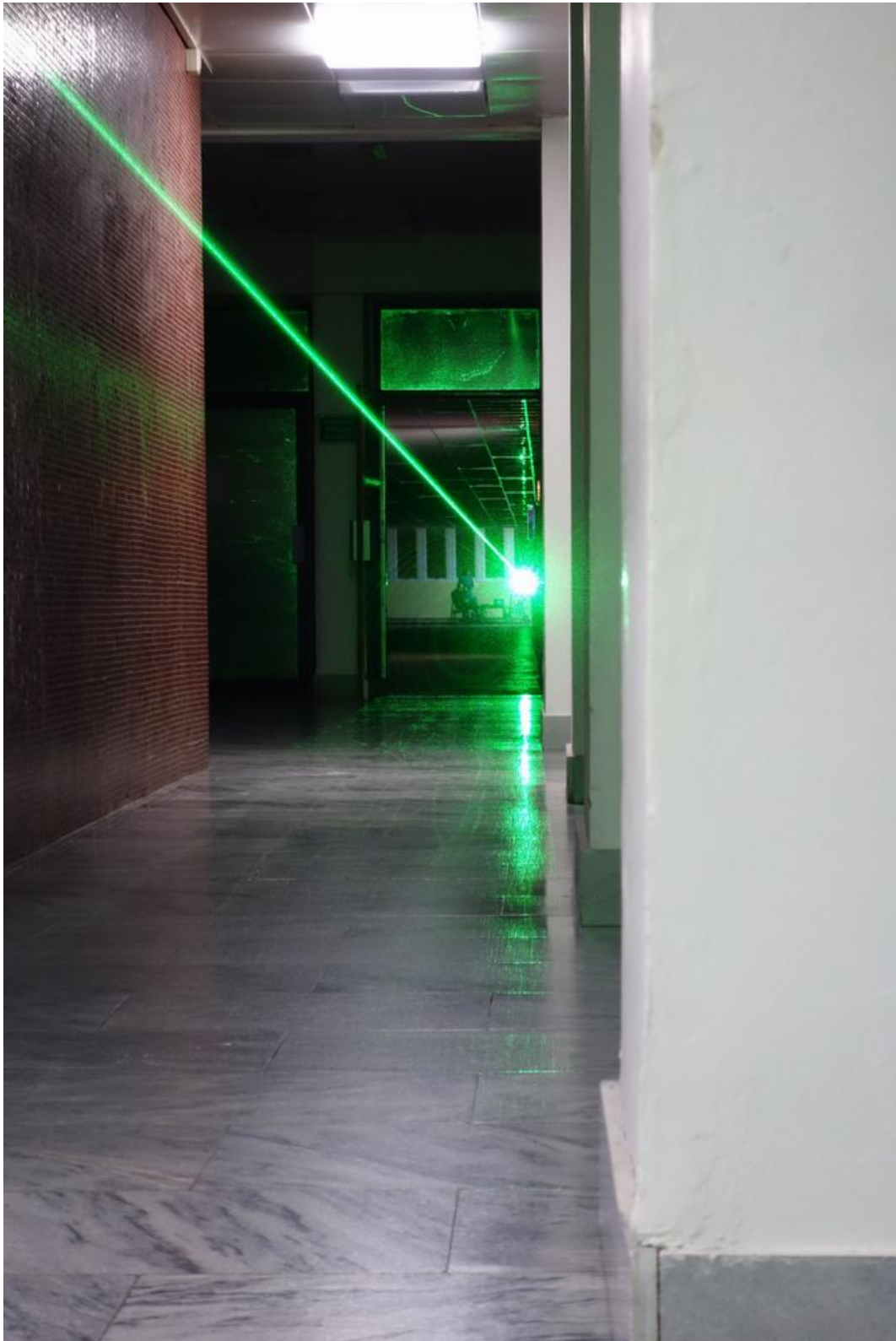
Obr. B.2: Testování optické části, vzdálenost 90 metrů
