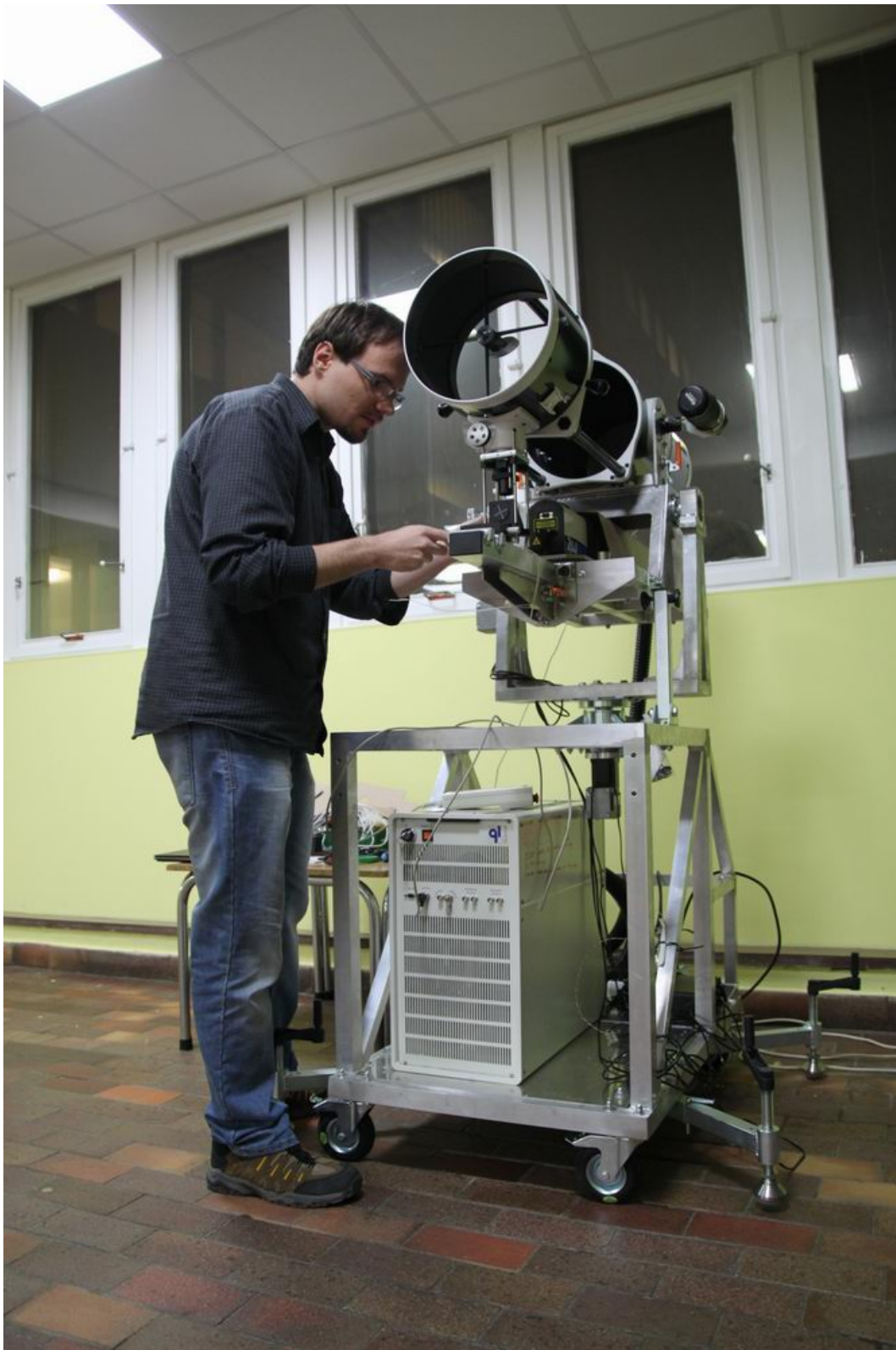
Obr. B.1: Celé zařízení rLIBS při testování optické části
