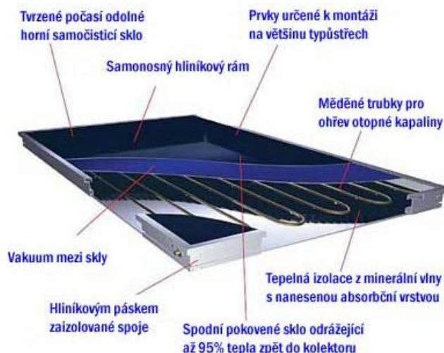
Obrázek 2: Schéma plochého vakuového kolektoru [13]
