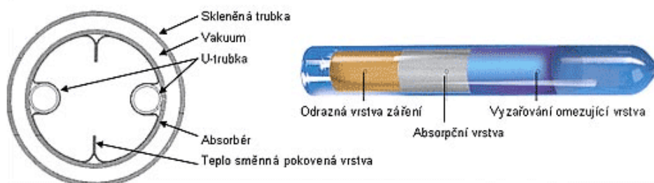
Obrázek 4: Řez vakuovou trubicí [14]
