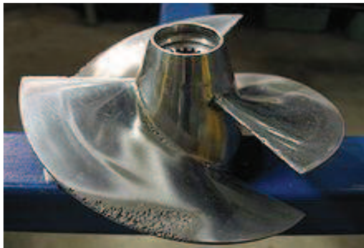
Obr.5 . 3 Lodní šroub poškozený kavitací [10]
