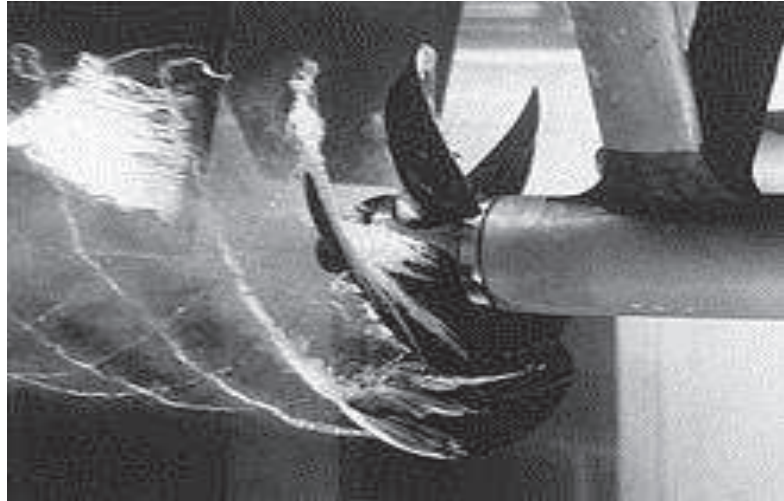
Obr.5 . 2 Turbulence a kavitace způsobené otáčením lodního šroubu [10]
