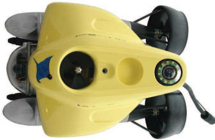
Obr.3. 2 Robot „PRO 4ROV SYSTÉM“ pohled shora na pohon pro regulaci hloubky [22]
