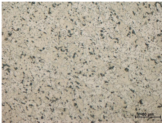
Obr. 15 Tvářená slitina 2618 v nežíhaném stavu, zvětšení 500x
