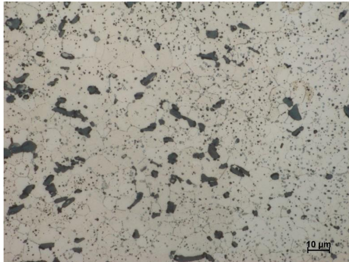
Obr. 18 Tvářená slitina po čtyřech hodinách žhání na 200 °C, zvětšení 1000x
