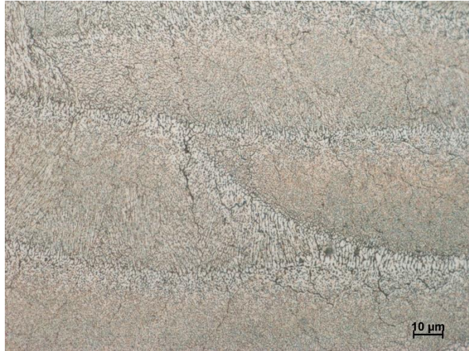
Obr. 36 Slitina 2618 připravená pomocí SLM po šestnácti hodinách žihání na 200 °C, zvětšení 1000x
