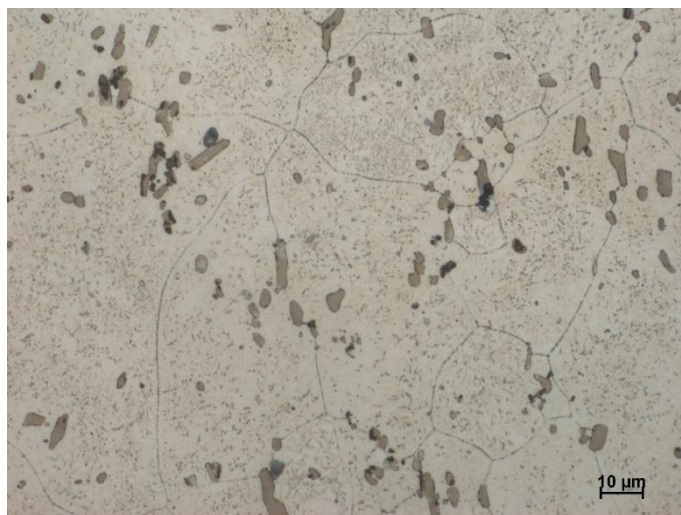
Obr. 24 Tvářená a vytvrzená slitina 2618 v nežíhaném stavu, zvětšení 1000x
