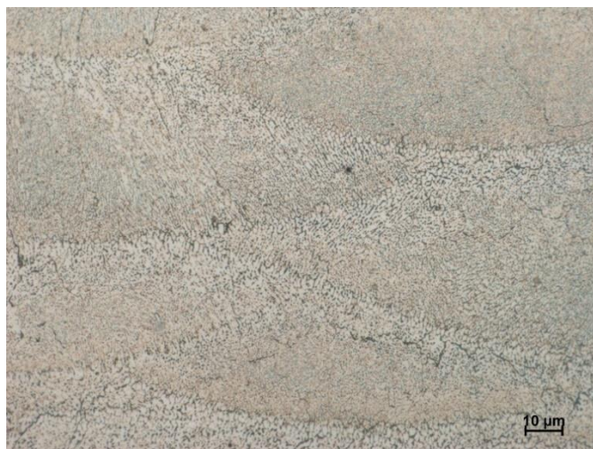
Obr. 33 Slitina 2618 připravená pomocí SLM po čtyřech hodinách žíhání na 190 °C, zvětšení 1000x
