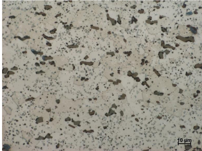
Obr. 17 Tvářená slitina po čtyřech hodinách žhání na 190 °C, zvětšení 1000x
