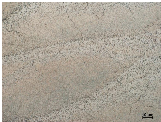
Obr. 34 Slitina 2618 připravená pomocí SLM po čtyřech hodinách žíhání na 200 °C, zvětšení 1000x
