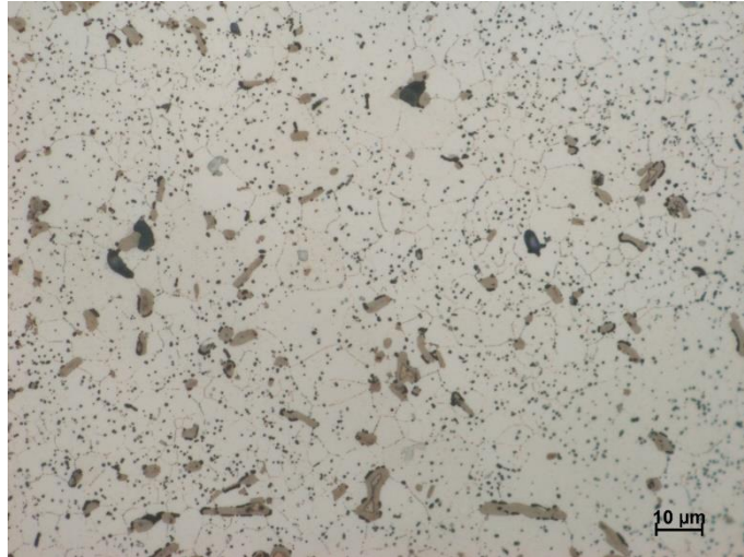
Obr. 20 Tvářená slitina po šestnácti hodinách žihání na 200 °C, zvětšení 1000x
