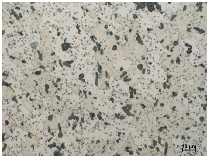
Obr. 16 Tvářená slitina 2618 v nežíhaném stavu, zvětšení 1000x
