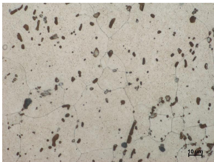
Obr. 26 Tvářená a vytvrzená slitina po čtyřech hodinách žíhání na 200 °C, zvětšení 1000x
