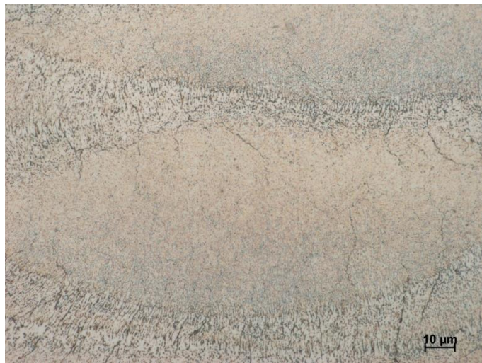
Obr. 32 Slitina 2618 připravená pomocí SLM v nežíhaném stavu, zvětšení 1000x
