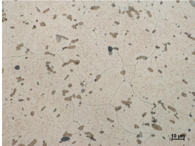
Obr. 27 Tvářená a vytvrzená slitina po šestnácti hodinách žíhání na 190 °C, zvětšení 1000x
