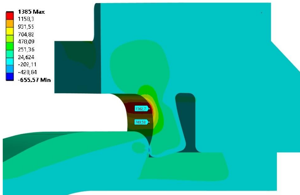
Obr. 32.: Místa vzniku maximálního napětí při montážní zkoušce
