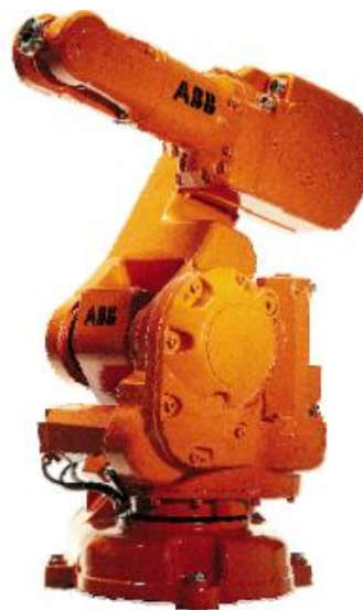
Obr. 10) Angulární pohybová struktura / Robot firmy ABB [9]
