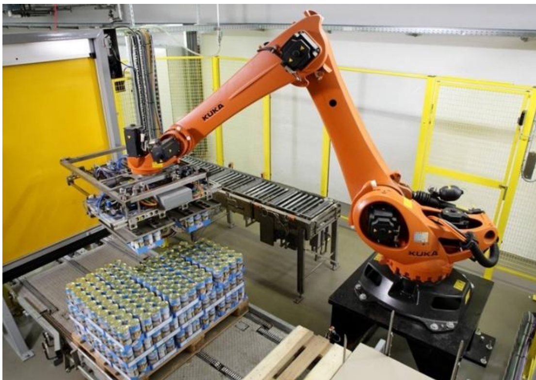
Obr. 3) Příklad manipulační operace pomocí robotu (paletizace) [2]
