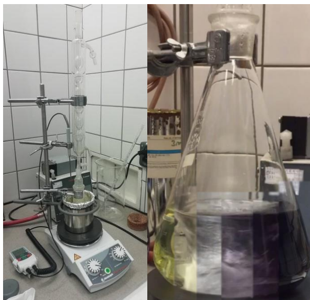
Obr. 21: Aparatura na syntézu AuNPs a změna barvy roztoku při syntéze AuNPs pro další experimenty
