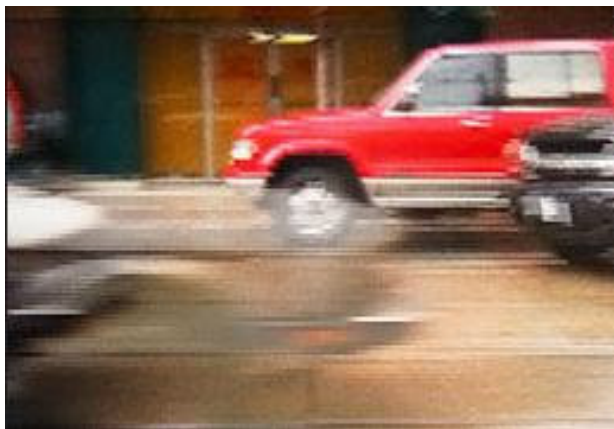
Obr.5: Výsledek sečtení dvou půlsnímků z Obr.3 a Obr.4
