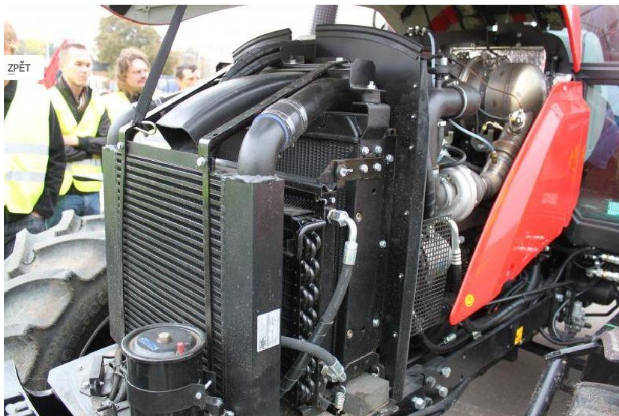
Obr. 4.1.3 Umístění filtru DPF [12]
