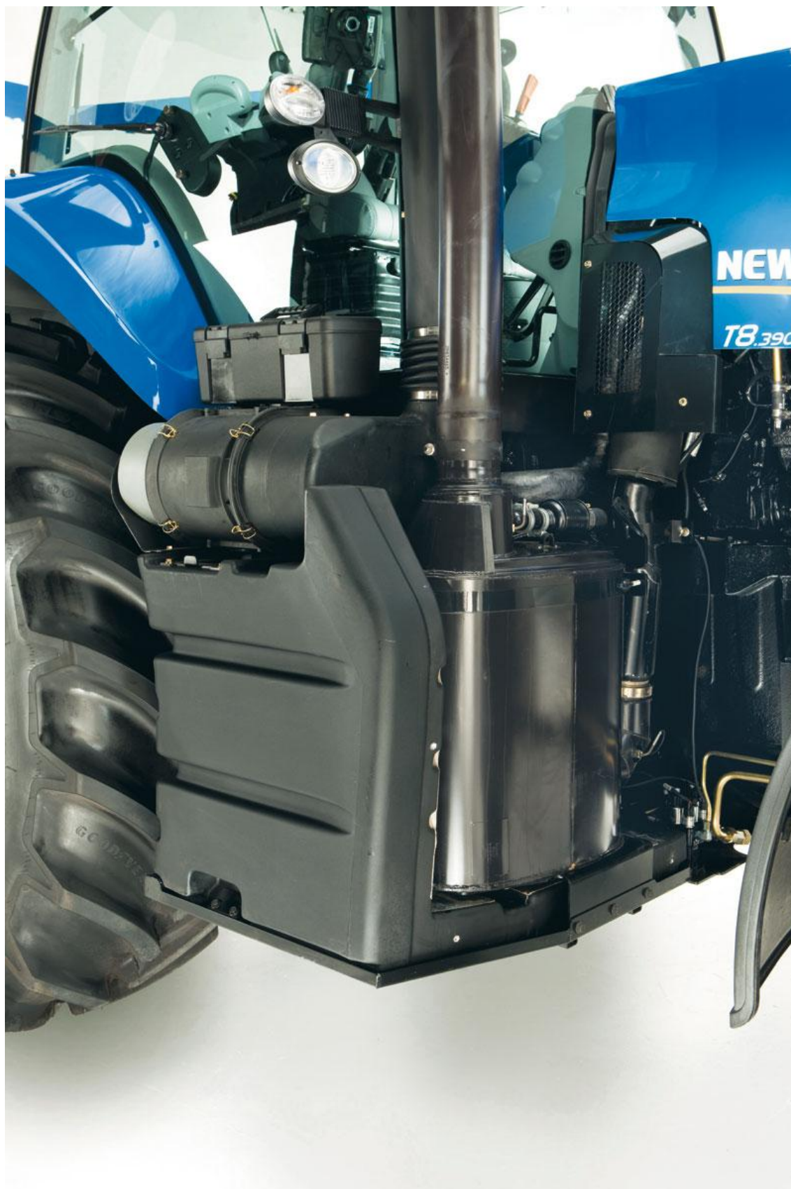
Obr. 4.7.6 Umístění katalyzátoru SCR u traktorů NH T8000 [22]
