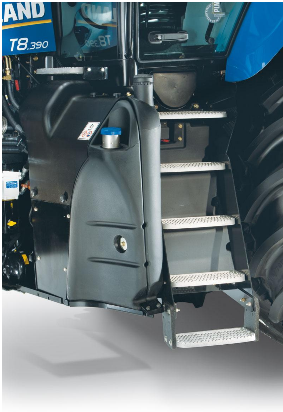
Obr. 4.7.5 Umístění nádrže Adblue u traktorů NH řady T8000 [22]
