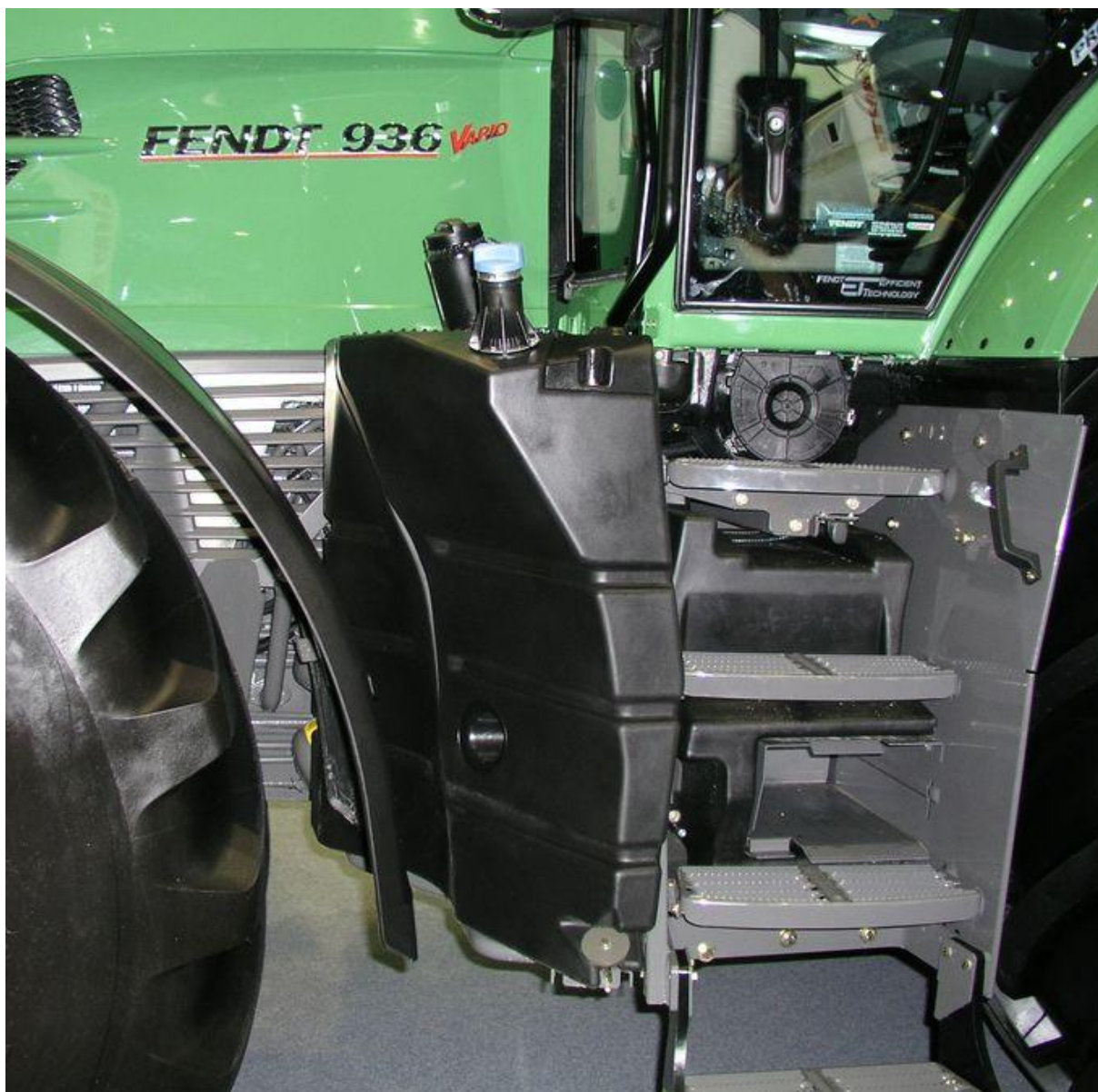
Obr. 4.8.3 Umístění nádrže AdBlue traktoru Fendt 936 SCR Vario [25]
