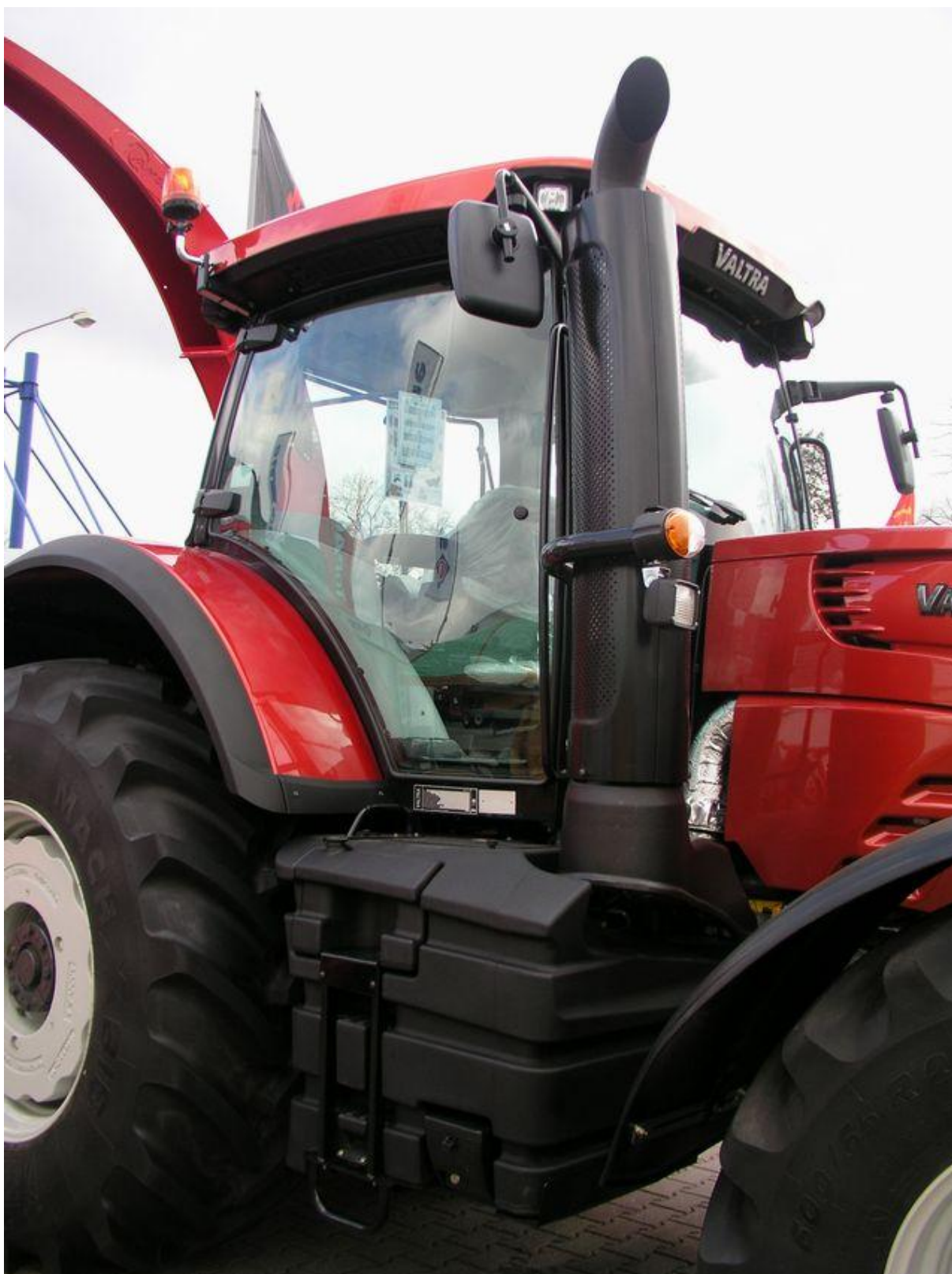
Obr. 4.5.3 Umístění katalyzátoru a výfuku traktoru Valtra [25]
