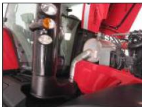
Tlumič výfuku vychází z oxidačního katalyzátoru (DOC) a vstupuje do svislého výfukového potrubí obsahujícího katalyzátory
