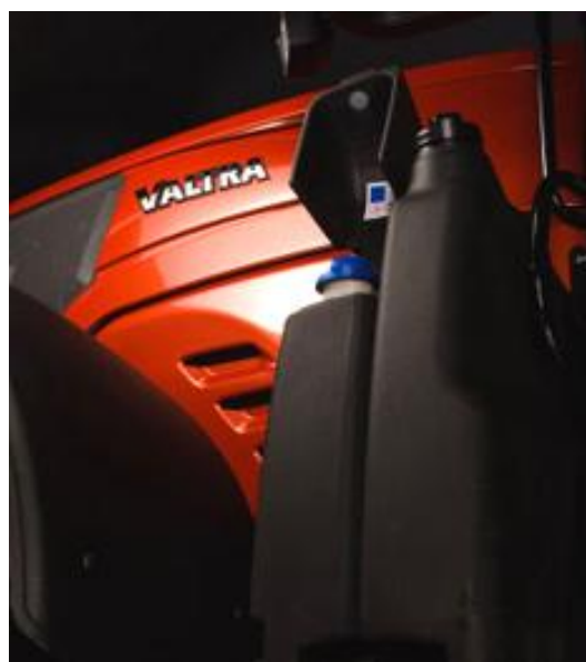
Obr. 4.5.2. Umístění nádrže AdBlue i traktoru Valtra [19]
