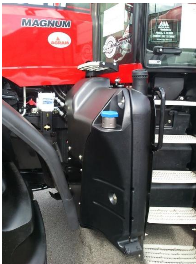
Obr. 4.4.3. Umístění nádrže AdBlue u traktoru Case [25]
