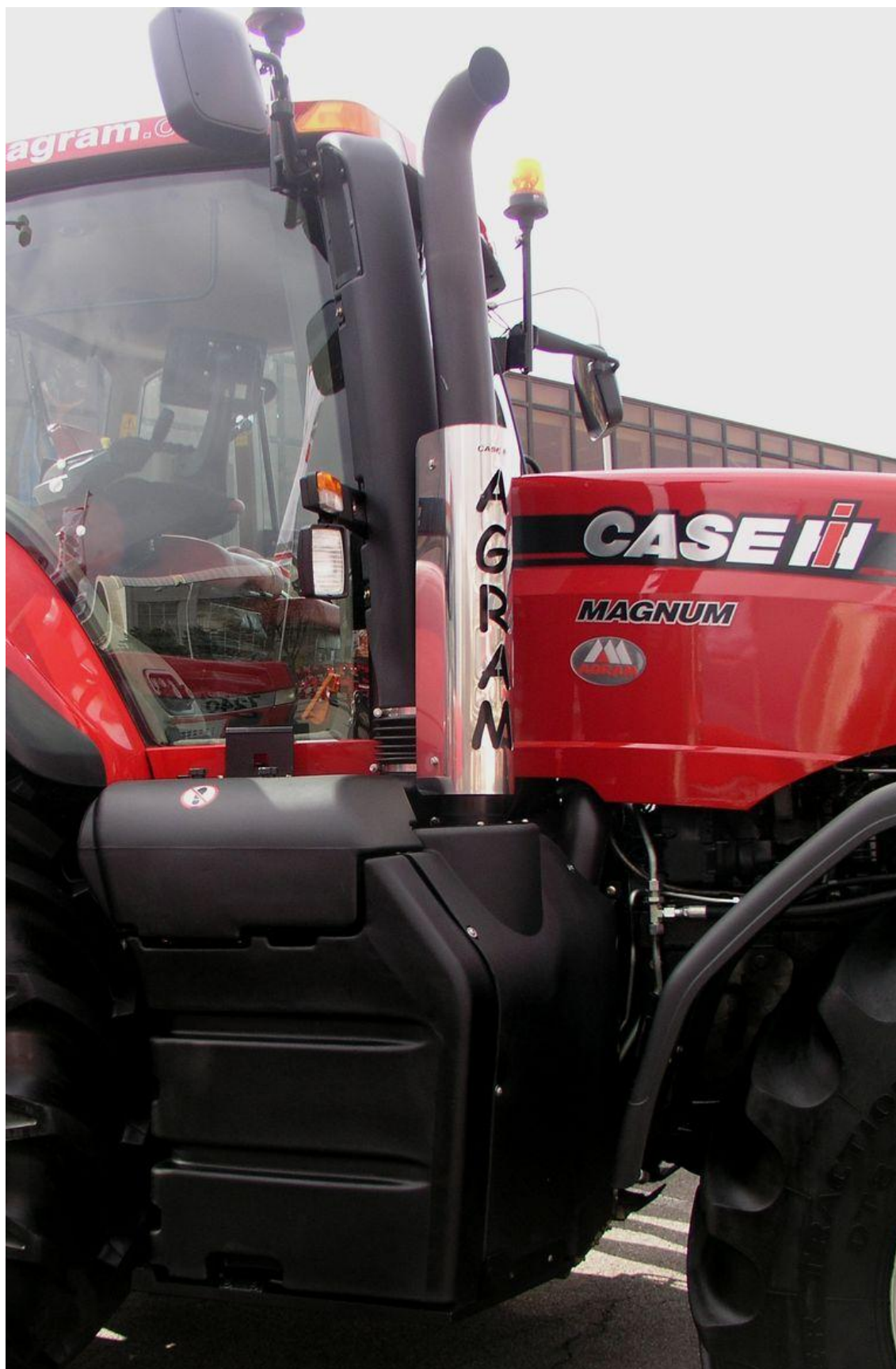
Obr. 4.4.4 Umístění katalyzátoru a výfuku traktoru Case [25]
