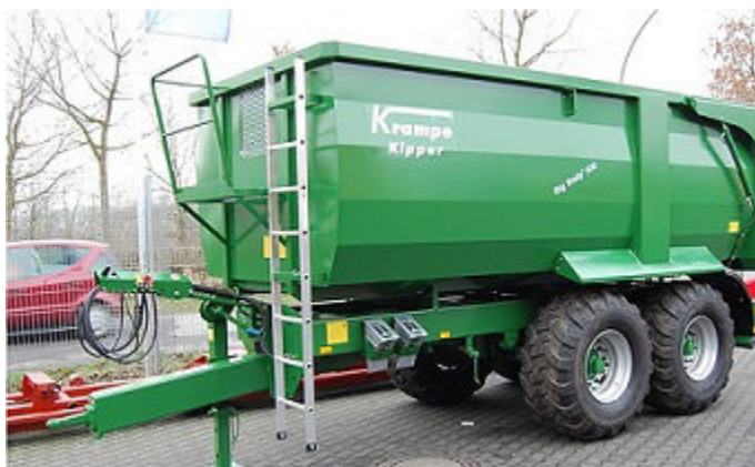
Obr.29 Obslužná plošina, pevný žebřík [22]
