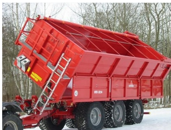
Obr.7 2-stranně sklápěná korba ZDTM-2540[14] Obr.8 3-stranně sklápěná korba Annaburger[18]
