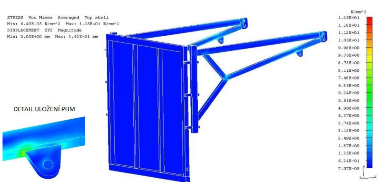
Obr.59 Redukované napětí na zadním čele při volném otevírání, dle metody HMM. Maximální napětí 12,5 MPa, zobrazení deformace v měřítku 20:1
