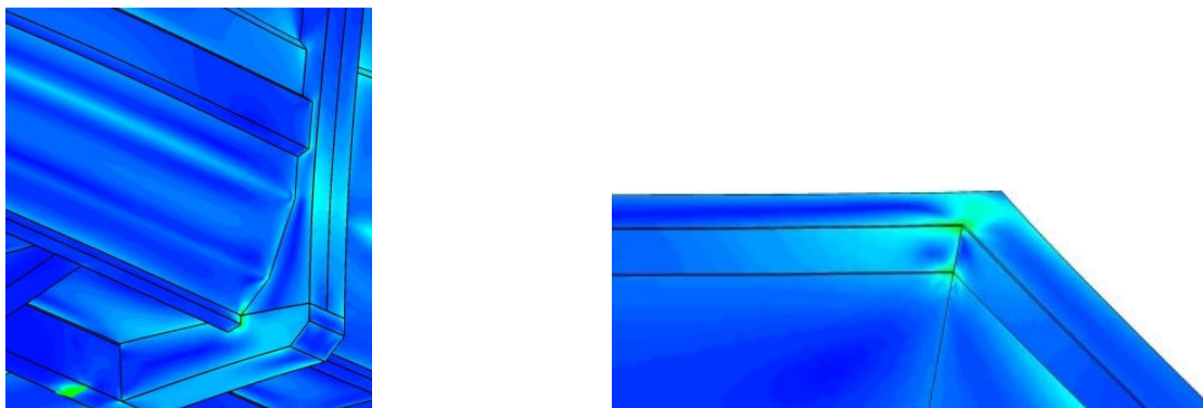
Obr.77 Detaily napětí na korbě při jízdě v zatáčce
