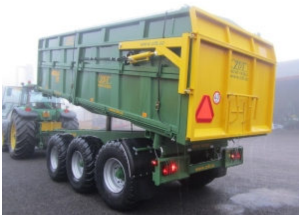
Obr.7 2-stranně sklápěná korba ZDTM-2540[14] Obr.8 3-stranně sklápěná korba Annaburger[18]
