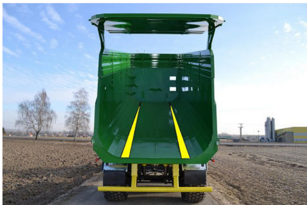
Obr.18 Kónické rozšíření korby [17]
