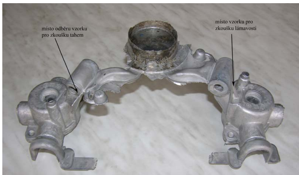
Obr. 9. Vzhled odlitku s návrhem hodnocení mechanických vlastností
