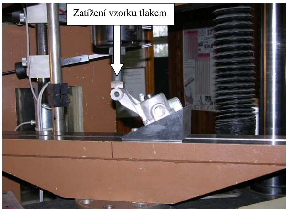
Obr. 12. Vzhled přípravku a umístění odlitku při zkoušce lámavosti
