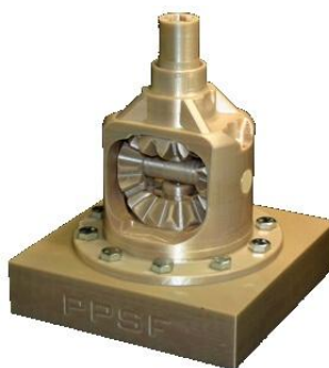
Obr.:28, Výrobek z PPSF(polyfenylsulfan)[29]
