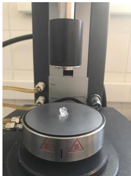
Obrázek 31: Reometr s hydrogelem A
