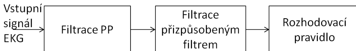
Obrázek 9: Blokové schéma detektoru využívajícího přizpůsobenou filtraci
