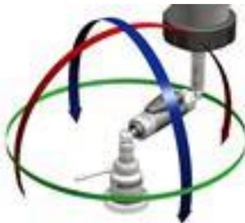
Obr. 1.3: Měření volumetrické přesnosti systémem ballbar (10)
