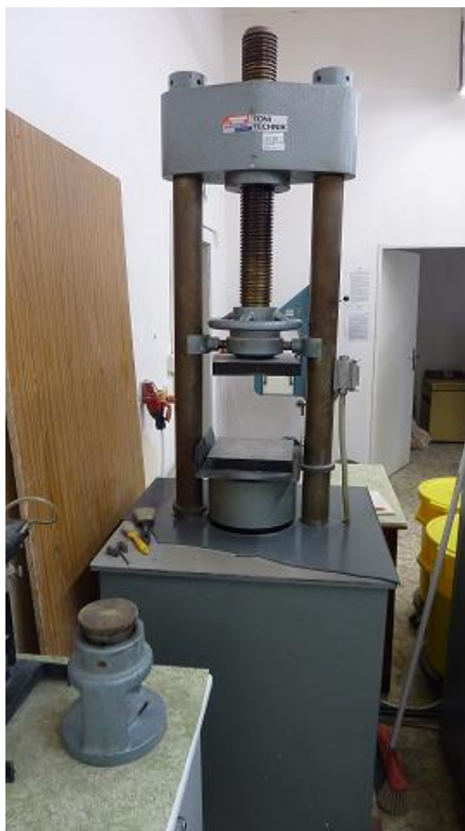
Obr. 14 Zkušební lis pro stanovení pevnosti v tlaku
