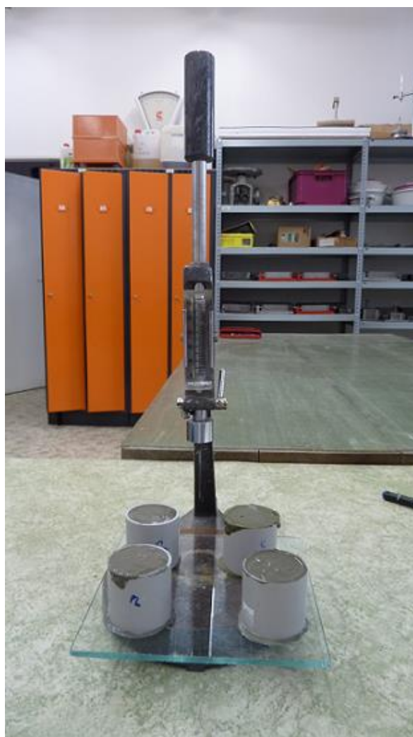
Obr. 12 Vicatův přístroj pro stanovení dob tuhnutí
