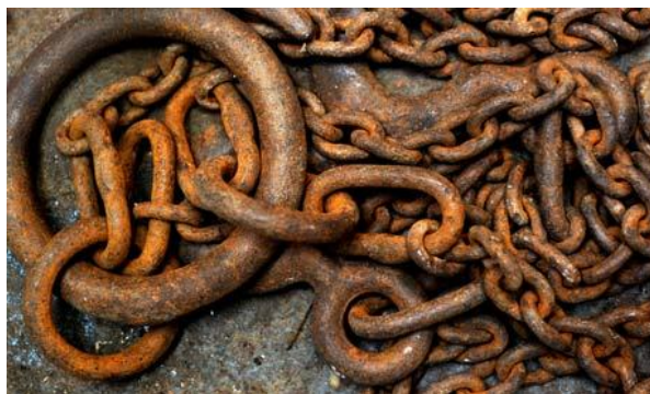
Obr. 2 Rez na povrchu ocelového řetězu [8].
