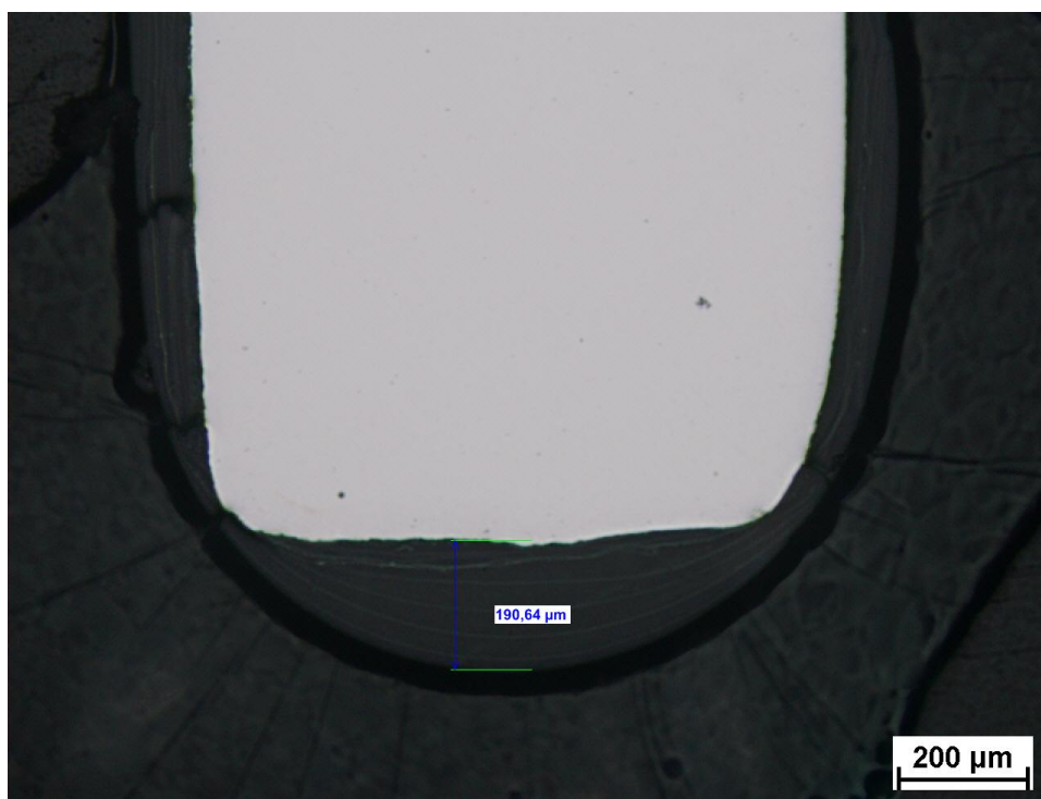
Obr. 6.8 Struktura sedmivrstvého povlaku a měření tloušťky ze spodního okraje vzorku.
