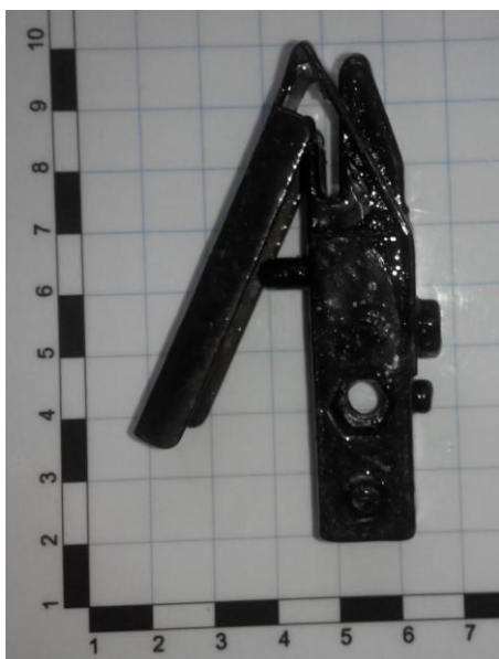
Obr. 6.1 Znečištění háčku lakem.
