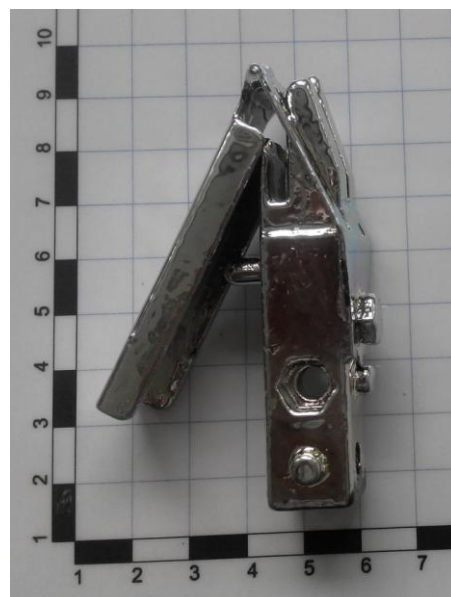
Obr. 6.2 Znečištění háčku nepravidelnou alternací laku a napařeného hliníku.
