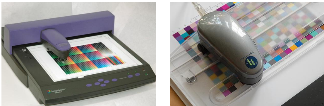
Obr. 10 Spektrofotometr Gretag Macbet Spectroscan (vlevo) a spektrofotometr Eye One X-Rite (vpravo)
