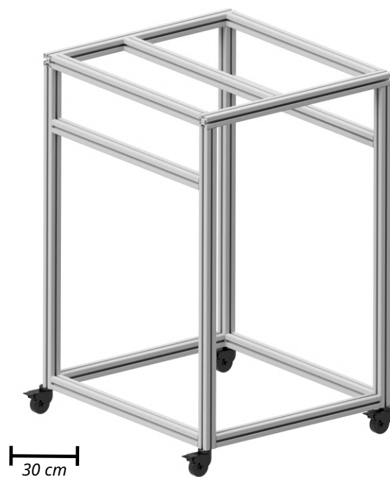
Obr. 3.5: Model rámu v softvéri Inventor.
