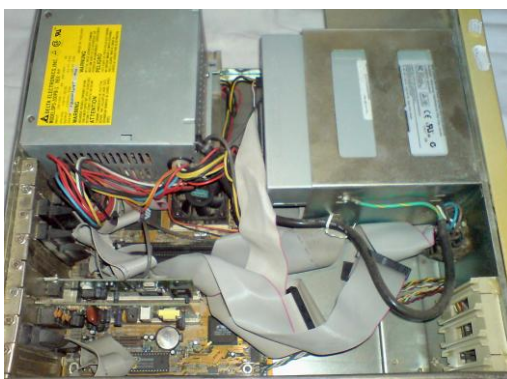
Rozmístění komponent u staršího typu PC – obr. 28
