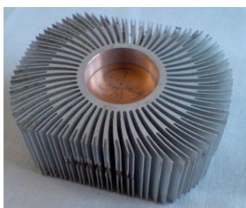
Pasivní chladič CPU – INTEL s měděným jádrem – obr. 17
