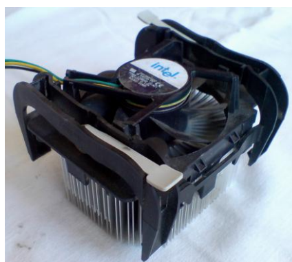
Kombinace pasivního chladiče CPU - INTEL s ventilátorem – obr. 18
