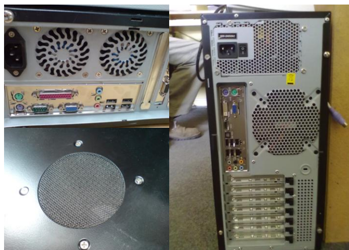
Různé perforace plechu počítačových skříní – obr. 11
