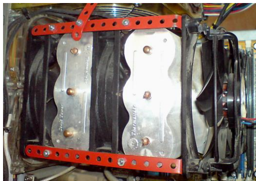
Detail provedení chlazení procesoru – obr. 32
