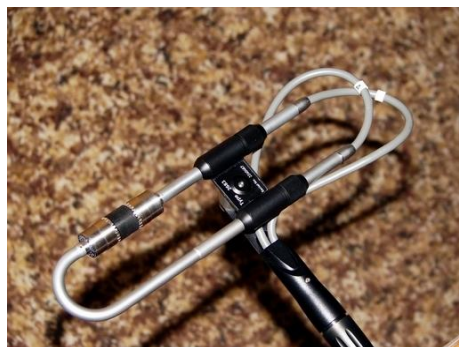
Ukázka páru mikrofonů na intenzitní sondě – obr. 40
