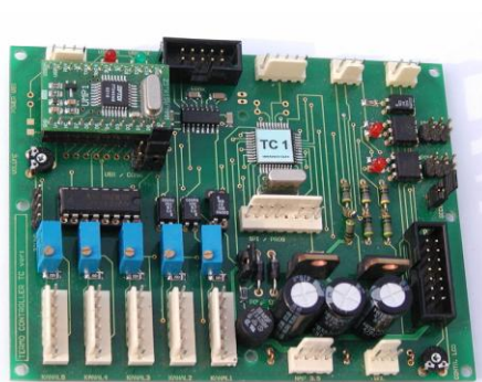
Termocontroler TC1 firmy CASH – regulační deska – obr. 27
