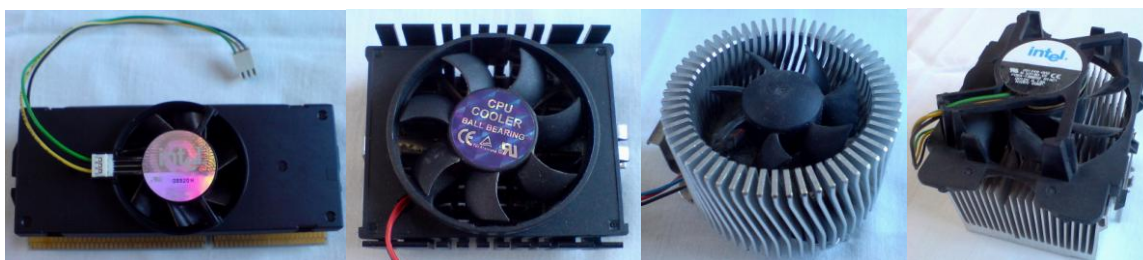
Ukázky ventilátorů – tvaru lopatek a provedení pro chlazení CPU – obr. 19
