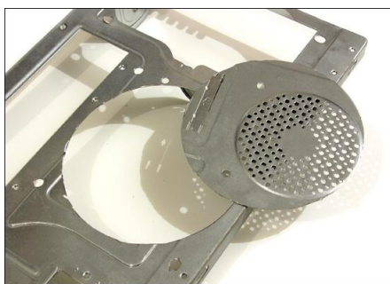
Vyříznutí otvoru pro ventilátor Ø 120 mm - obr. 33
