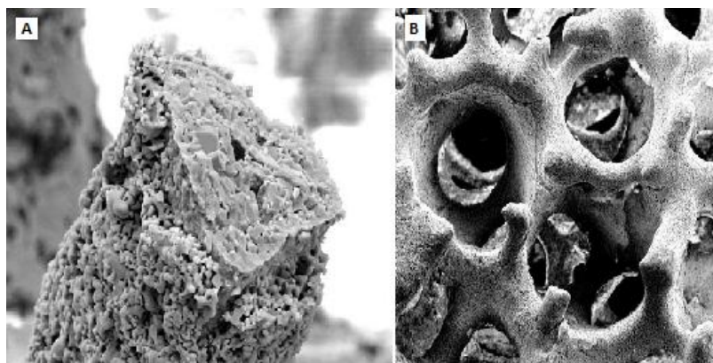
Obr. 4. 6 A- vlákno Al_2O_3 pokryté vrstvou HA, B- pohled na celkovou kompozitní strukturu [49]
